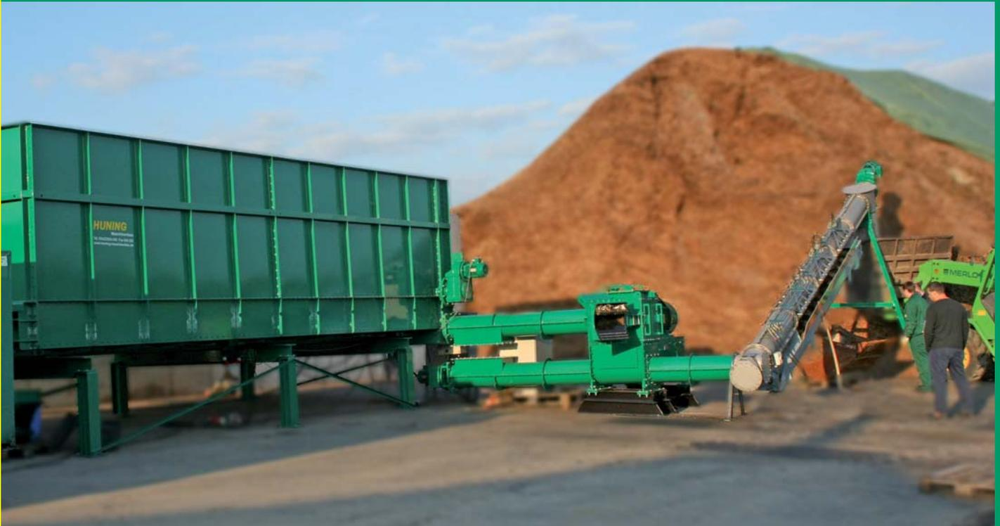
*Schubboden mit störstoffunempfindlicher Spiralfördertechnik zur Lagerung und Dosierung von unterschiedlichsten Ausgangsstoffen*
